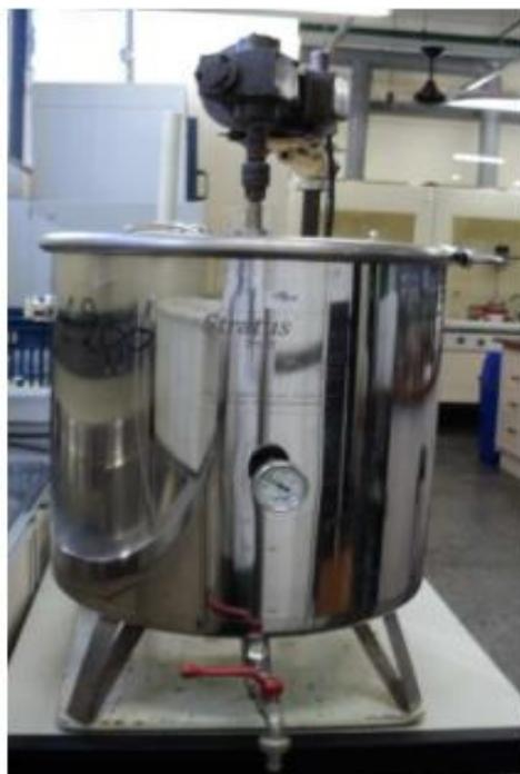
Figura 6 – Tanque de aço inoxidável utilizado para descontaminação da madeira tratada com CCA em escala piloto (4,5 kg de madeira para 30 L de solução extratora)
