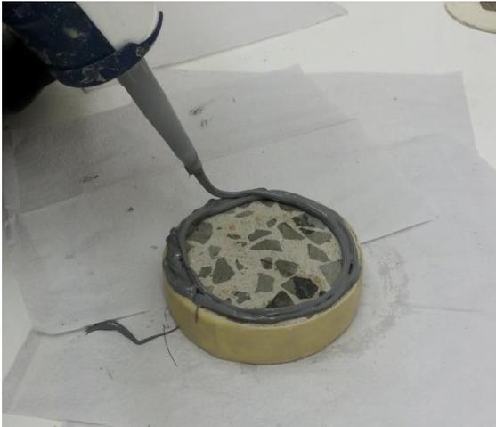
(a) Colocação de selante poliuretano PU para colagem da tampa de PVC
