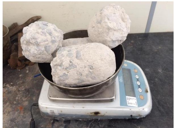
(b) Pesagem das amostras após o ensaio.
