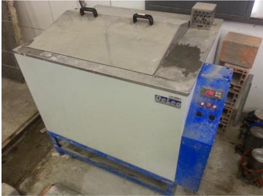
(a) Procedimento de saturação dos corpos de prova
