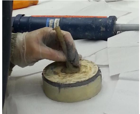
(b) Encaixe da tampa de PVC a 2 mm da face do corpo de prova
