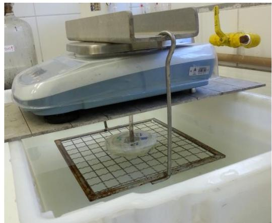
(b) Pesagem em balança hidrostática
