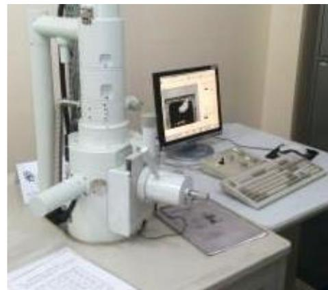
(b) Microscópio eletrônico de varredura.
