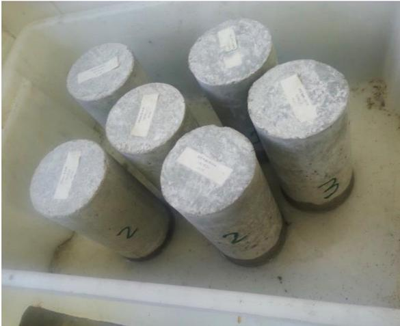
(a) Colocação dos corpos de prova em contato com lâmina d'água
