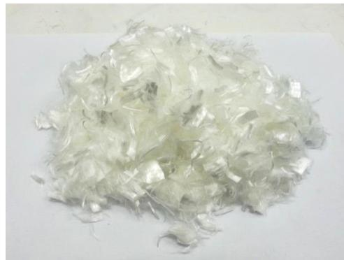
Figura 16 – Fibra de polipropileno monofilamento.
