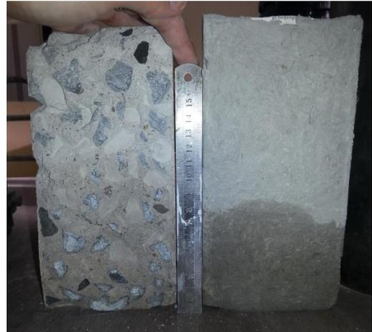
(b) Medição da altura de penetração da água nos corpos de prova
