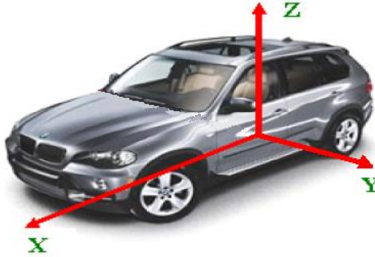
Figura 3.8: Sistemas fixo de coordenadas no veículo. Adaptado de (Maklouf, Ghila, Abdulaa, & Yousef, 2013).
