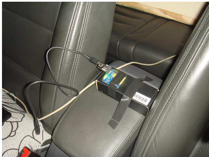
Figura 4.2: Posição da IMU aproximadamente no centro do veículo.
