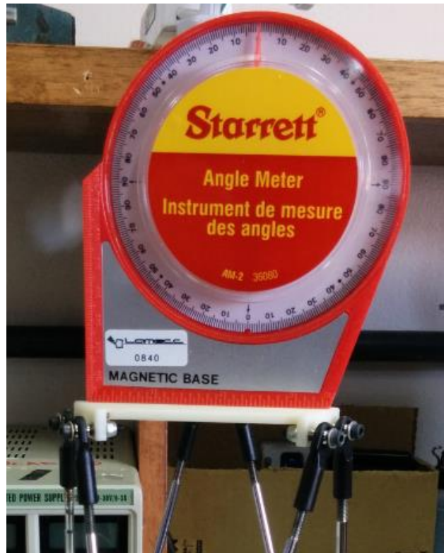
Figura 16: verificação da inclinação da plataforma para a pose inicial.
