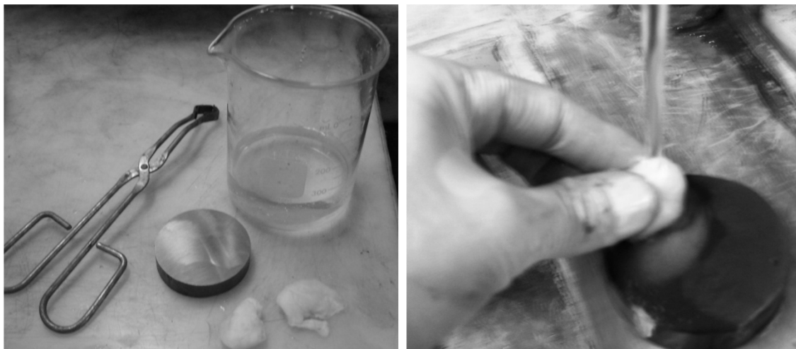
Figura 3.5 Dispositivos empregados nos ataques com persulfato de amônio. À direita etapa de remoção do lodo formado pelos produtos de reação.
