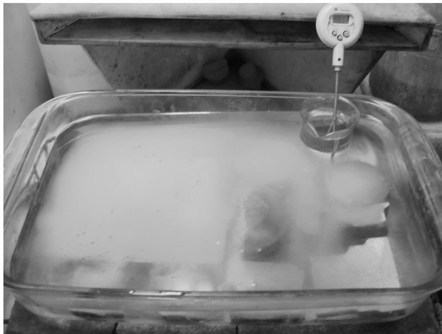
Figura 3.4 Aparato utilizado para ataque com ácido clorídrico (chapa de aquecimento e termômetro digital).
