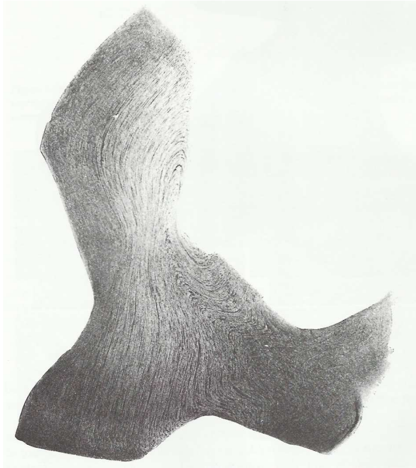
Figura 2.1 Linhas de deformação, em braço de direção de aço AISI 4140 forjado em matriz fechada, reveladas por ataque a quente em solução aquosa 50% HCl (1/2X). (VANDER VOORT, 1999)
