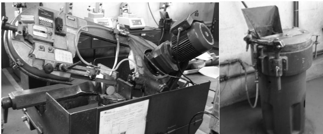
Figura 3.3 Equipamentos utilizados para preparação de amostras. À esquerda serra fita; à direita esmeril horizontal.
