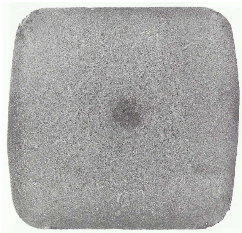
Figura 2.2 Tarugo de aço AISI 1050 atacado em ácido à quente, revelando a segregação no núcleo (1/2X). (VANDER VOORT, 1999)
