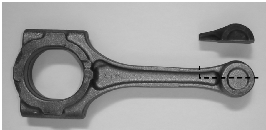
Figura 3.2 Biela forjada usada para comparação da capacidade dos reagentes, ácido clorídrico e persulfato de amônio, em revelar as linhas de deformação. No detalhe amostra já cortada e atacada (1/2X).
