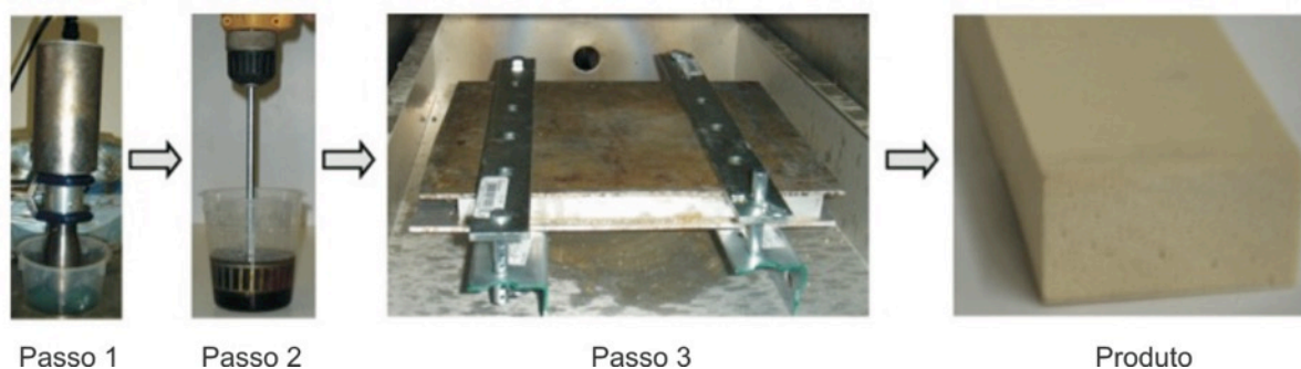
Figura 24 – Passo a passo do método de impregnação de microcápsulas em espumas de PU desenvolvido por Saha, Kabir e Jeelani
