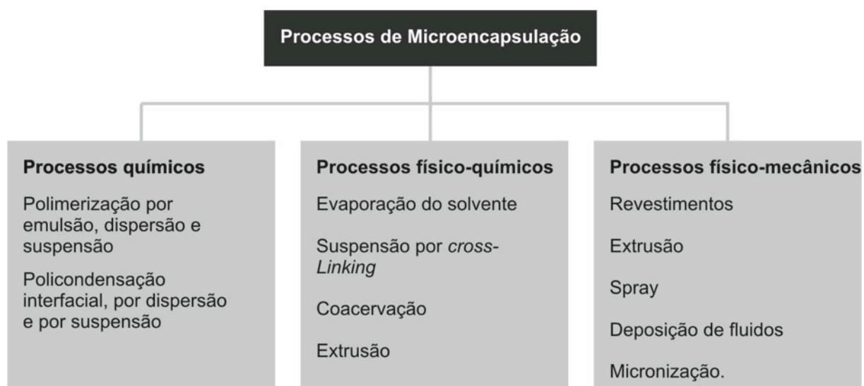
Figura 13 – Processos possíveis de microencapsulação
