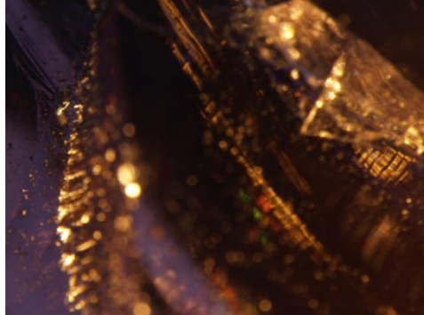
Figura 28. Imagem da escória aderida ao cacinho de grafite; experimento Tipo I (D) com CIAC bruta Fonte: Autora (2012)
