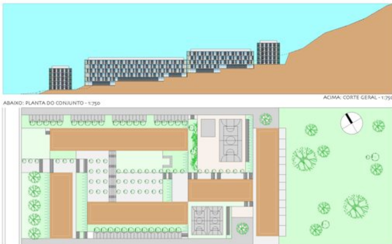
Figura 16. Elevação geral e Implantação.
