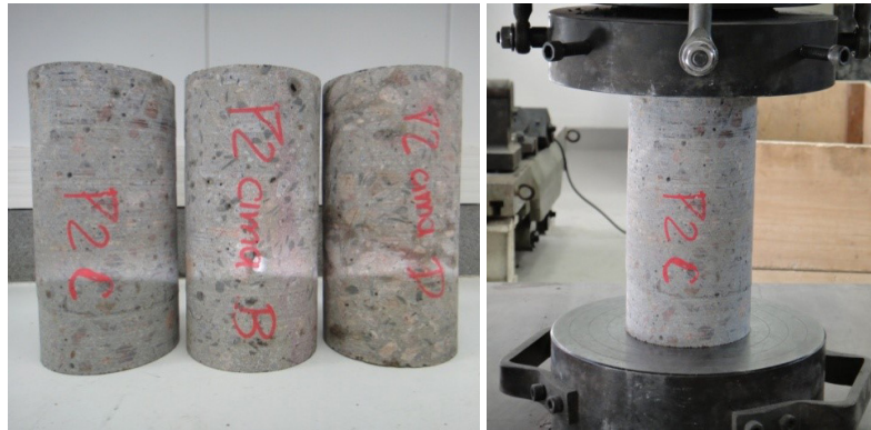
Figura 11: (a) corpos de prova extraídos (b) ensaio de compressão uniaxial efetuado em laboratório.
