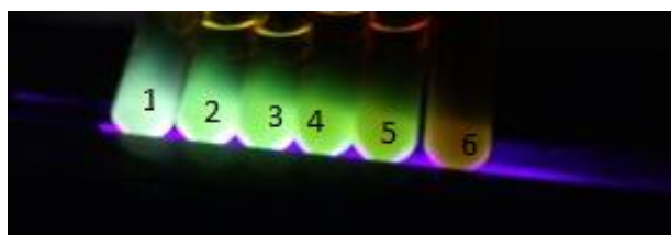
Figura 38. Fotografia dos PQs de CdSe extraídos em diferentes tempos da reação, iluminados com luz ultravioleta.
