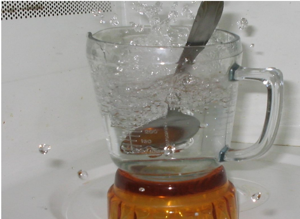
Figura 4 – Água superaquecida no forno de microondas irrompe em intensa ebulição quando uma colher é introduzida no recipiente.
