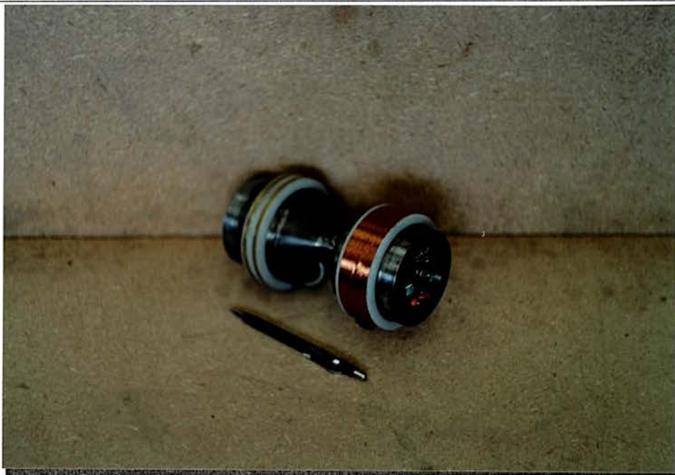
Foto III.1 - Secundário do transf. rotativo montado no eixo.
