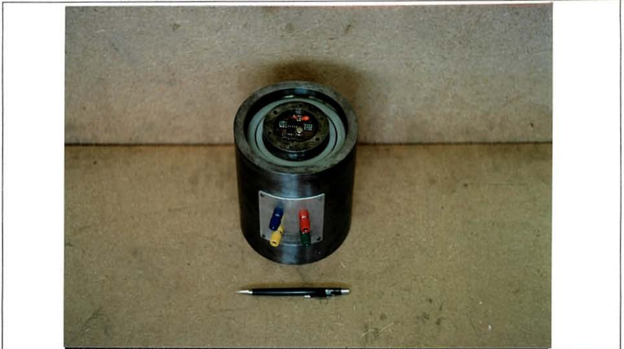
Foto II.1 - Aspecto do torquímetro construído.
