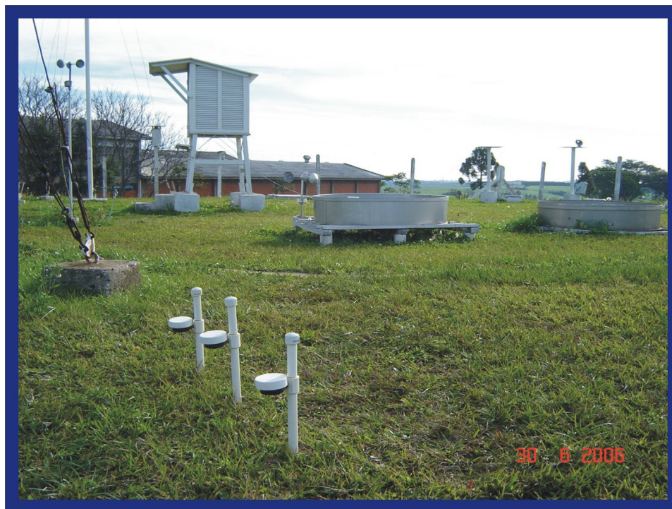
FIGURA 3.3.1.1 – Tensiômetros instalados da estação meteorológica da Embrapa Trigo, Passo Fundo, período de 16/02 a 31/03/2006.
