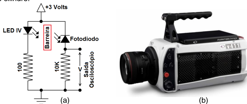
Figura 5.5 – Sistemas de calibração: (a) circuito emissor-receptor infravermelho; (b) câmera de alta velocidade.
