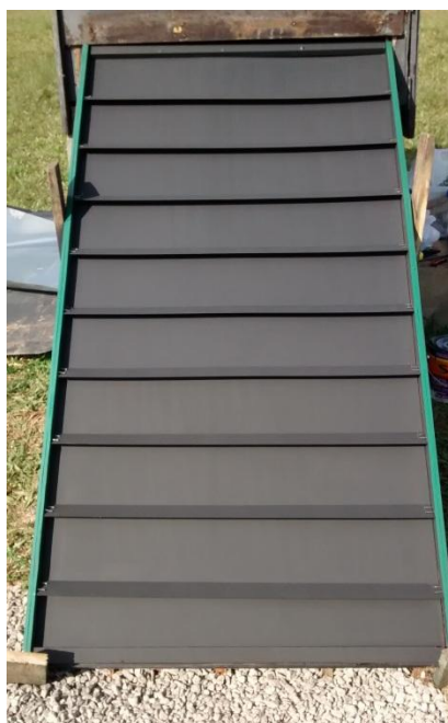
Figura 6.4 – Disposição das barreiras de convecção natural na parte superior da placa absorvedora.
