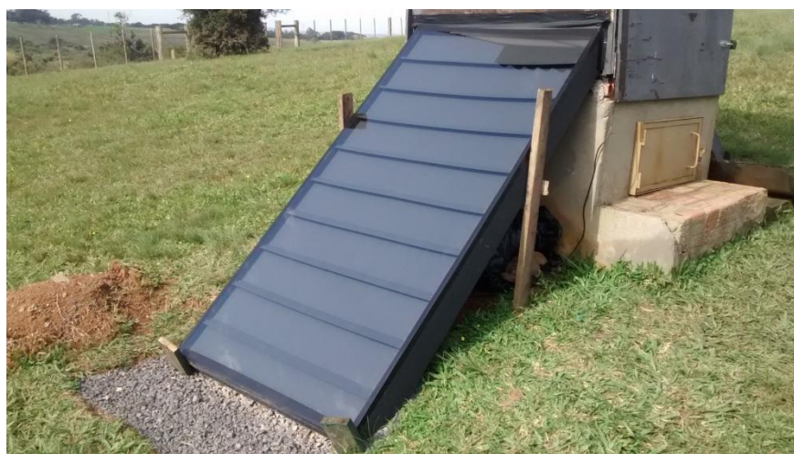
Figura 5.1 – Coletor solar montado na Fazenda Quinta da Estância.
