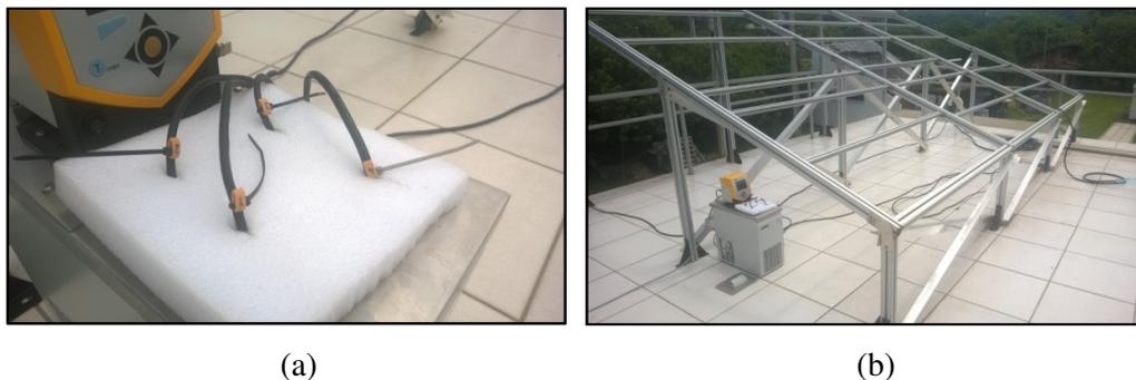
Figura 4.12 – Calibração dos sensores de temperatura por comparação com instrumento de banho térmico: a) fotografia aproximada com os quatro sensores; b) fotografia demonstrando a comparação realizada no local que os sensores serão instalados.
