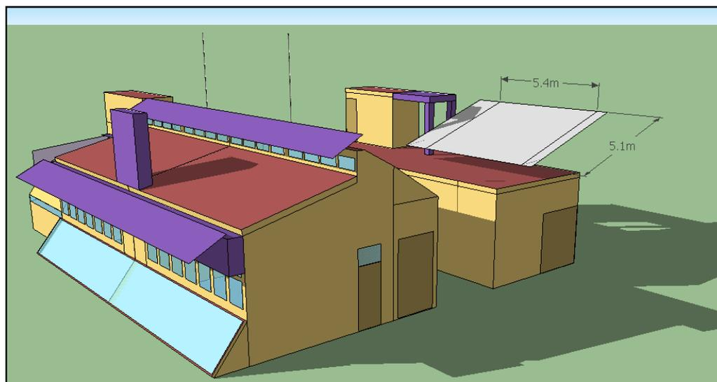
Figura 4.2 – Modelo tridimensional dos prédios do LABSOL com o software SkechtUp e incidência de radiação solar direta para 21/06 às dez horas da manhã.
