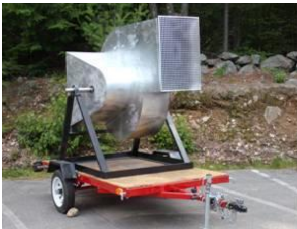
Figura 1.4 – Protótipo da turbina eólica de múltiplos discos criada pela empresa Solar Aero Research em 2010. A direita é apresentado mais detalhadamente o rotor do equipamento.
