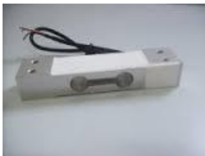
Figura 5.8 – Célula de carga utilizada na bancada experimental para a obtenção das medidas de torque e potência produzidas pela TMD
