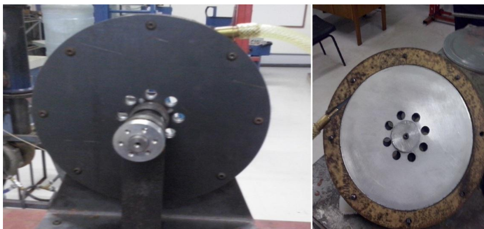
Figura 4.3 – Imagens do terceiro protótipo da TMD construído inteiramente em aço, mostrando a turbina montada sem o sistema de freio (esquerda) e a turbina aberta para destaque dos discos internos do rotor e do ponto de injeção do bocal (direita).
