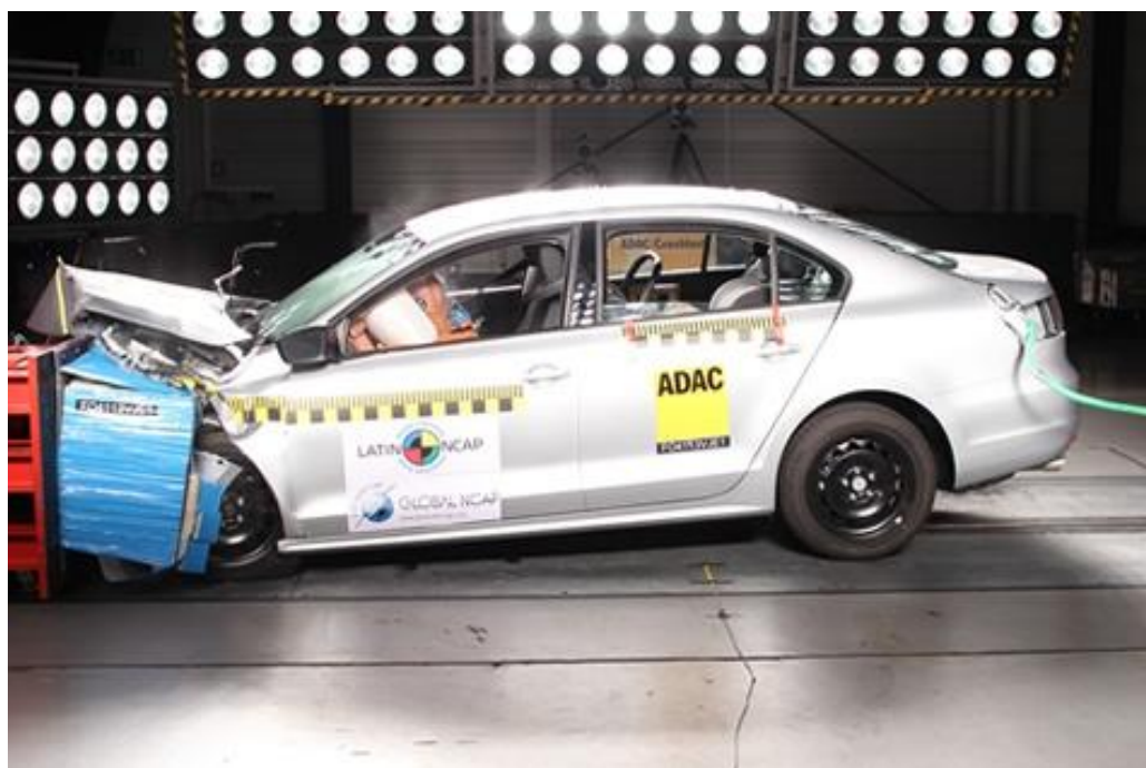
Figura 7: Crash test efetuado pela Latin Ncap no veículo VW Jetta.
