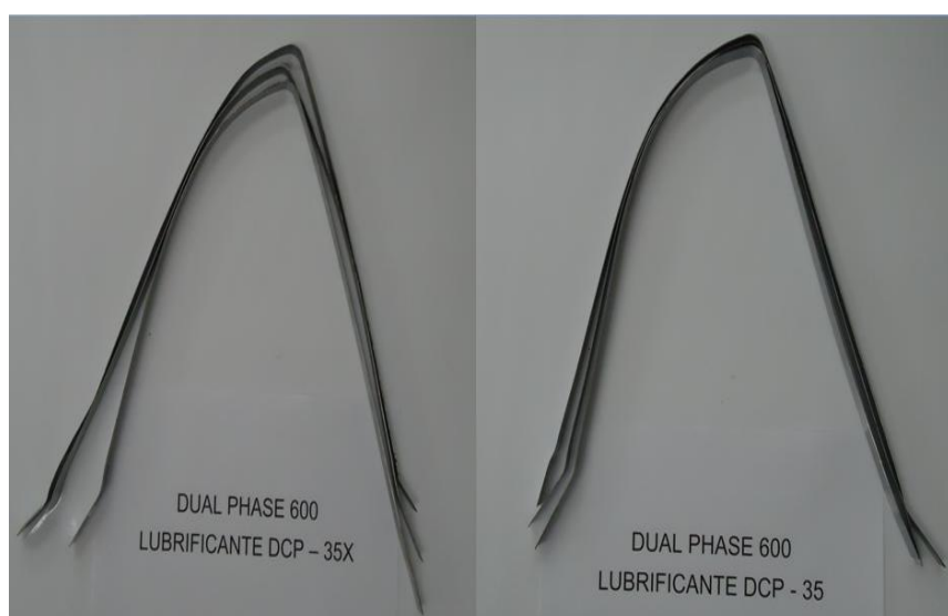
Figura 57: Amostras de tiras DP 600 após ensaio de dobramento DST com diferentes lubrificantes.
