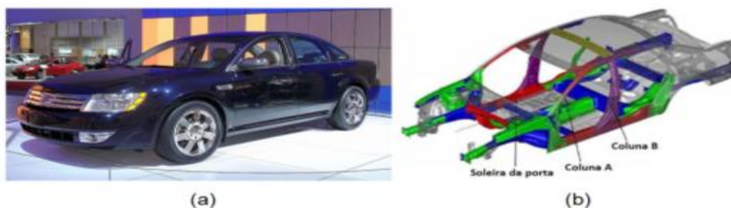
Figura 16: (a) Conceito Ford 500, posteriormente renomeado como Ford Taurus. Fonte: MOTORS TOWN, (2013); (b) Aplicação de aço DP600 na carroceria do Ford 500. Fonte: Adaptado de WORLD AUTO STEEL, (2009).
