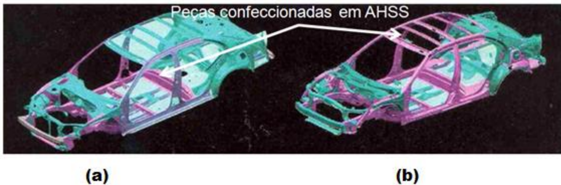
Figura 3: Comparativo do aumento na utilização dos aços bifásicos no Honda Civic, (a) geração 2005 com 32% de peças em aço bifásico e (b) geração de 2006 com 50% de peças em aço bifásico. Fonte: DIAS, (2013).
