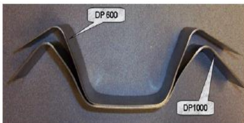
Figura 24. Retorno elástico na forma de variação angular para aços DP600 e DP1000. Fonte: MARRA, (2008).
