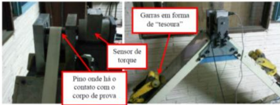
Figura 46. Detalhes dos garfos, sensor de torque e funcionamento da máquina usada para a realização do ensaio DST. Fonte: FOLLE, (2012).
