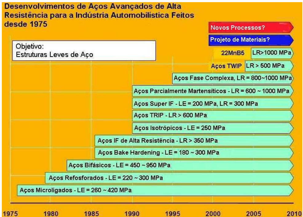
Figura 8: Evolução dos diversos tipos de Aços Avançados de Alta Resistência (AHSS) ao longo das últimas três décadas. Fonte: WUPPERMANN, (2007).
