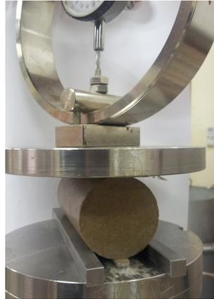
Figura 3.10 – Ensaio de Resistência à Compressão Diametral
