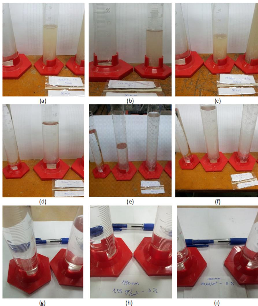
Figura 4.2 – Ensaio *Pinhole Test*: para  $16\text{ kN/m}^3$ ,  $17,5\text{ kN/m}^3$  e  $19\text{ kN/m}^3$  com adição de cal de 1%, (a)(b) e (c), respectivamente; para  $16\text{ kN/m}^3$ ,  $17,5\text{ kN/m}^3$  e  $19\text{ kN/m}^3$  com adição de cal de 2%, (d)(e) e (f), respectivamente; para  $16\text{ kN/m}^3$ ,  $17,5\text{ kN/m}^3$  e  $19\text{ kN/m}^3$  com adição de cal de 3%, (g)(h) e (i), respectivamente.
