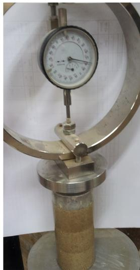
Figura 3.9 – Ensaio de Resistência à Compressão Simples
