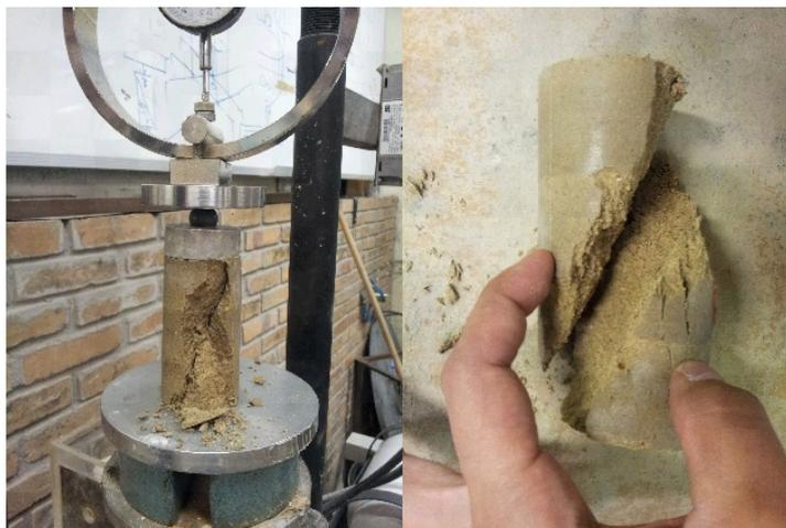
Figura 4.18 – Corpos-de-prova submetidos à compressão simples (Plano de ruptura típico)
