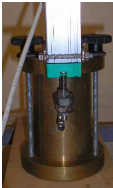
Figura 3.13 – Medidor externo de variação volumétrica em funcionamento
