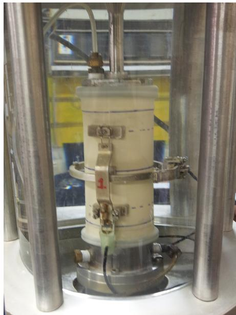
Figura 3.16 – Sensores de efeito Hall em funcionamento aderidos à amostra
