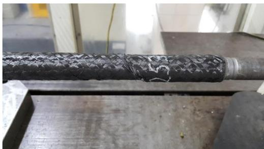
**Figura A1.4** – Ruptura de maneira frágil do eixo de material composto.
