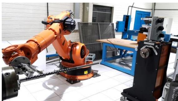
**Figure 2.2** - Técnica de *filament winding*.
