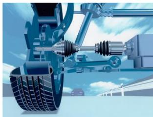
**Figura 2.1** – Semieixo homocinético instalado em veículo (www.gkn.com)
