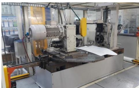
**Figura AI.1** – Máquina utilizada para a realização do teste de torção.
