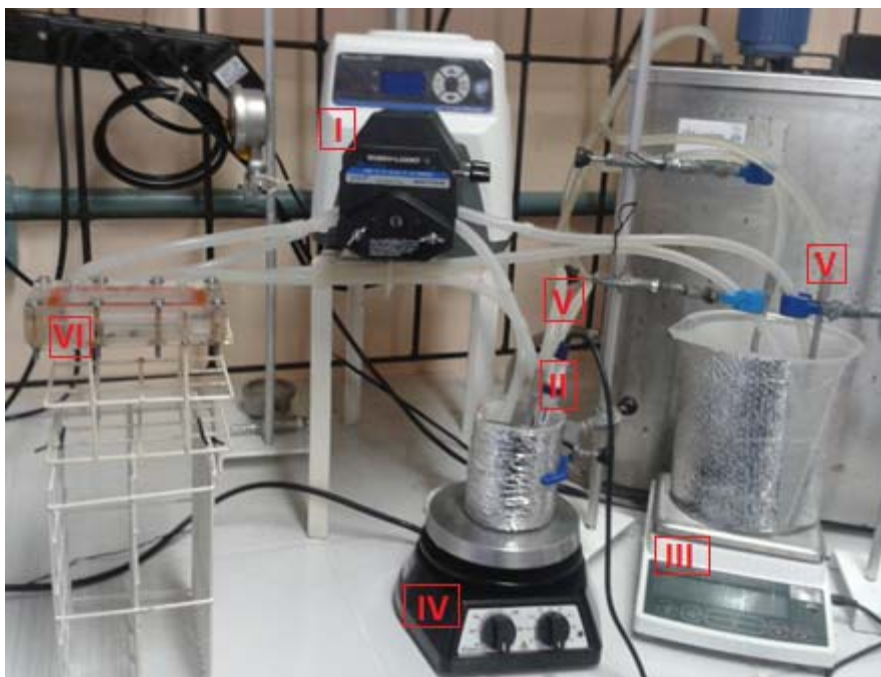
Figura 3.1: Fotografia da unidade de bancada de osmose direta.
