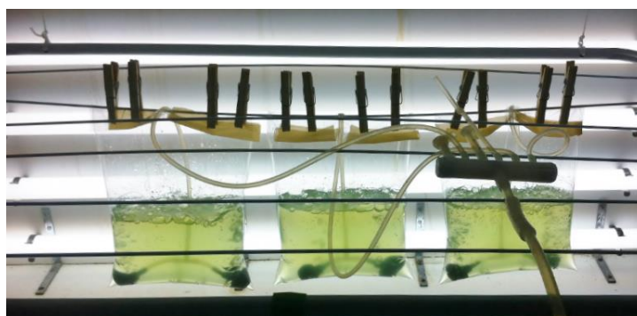
Figura 3.4: Sistema de cultivo da Scenedesmus sp. em fotobiorreatores de baixo custo.
