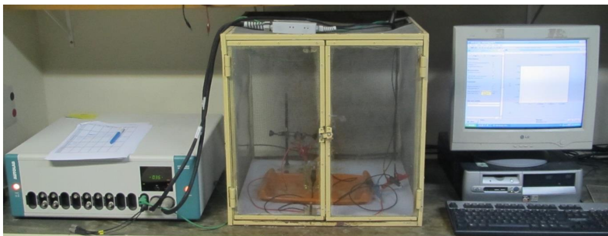
Figura 12 - Foto ilustrando os equipamentos utilizados. A esquerda o Autolab
