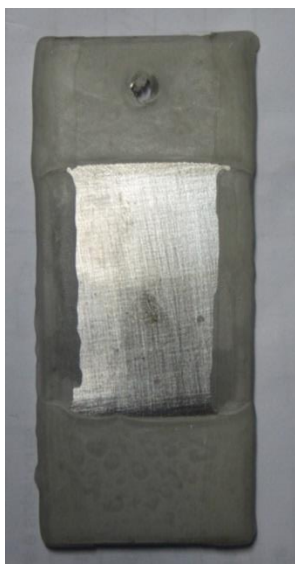
Figura 13 - Corpo de prova utilizado nos ensaios de polarização.
