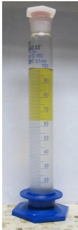
Figura 15 - Foto tirada para se registrar o resultado final dos ensaios segundo a NBR 13992 para gasolina comum comercial.
