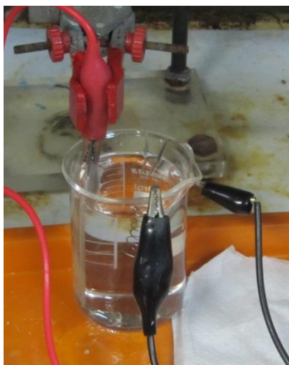
Figura 11 - Figura ilustrando o sistema que foi utilizado para se medir a curva de polarização das amostras.
