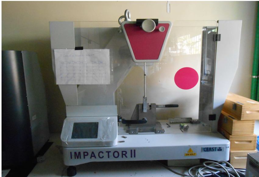
Figura 11: Máquina de ensaios de impacto CEAST IMPACTOR II.
