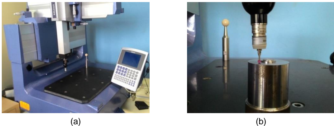
Figura 10: Medição dos desvios: (a) Mitutoyo QM-353; (b) procedimento de medição.
