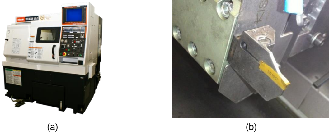
Figura 6: (a) Torno CNC Mazak QTN 100-II; (b) Ferramenta de corte usada nos experimentos.
