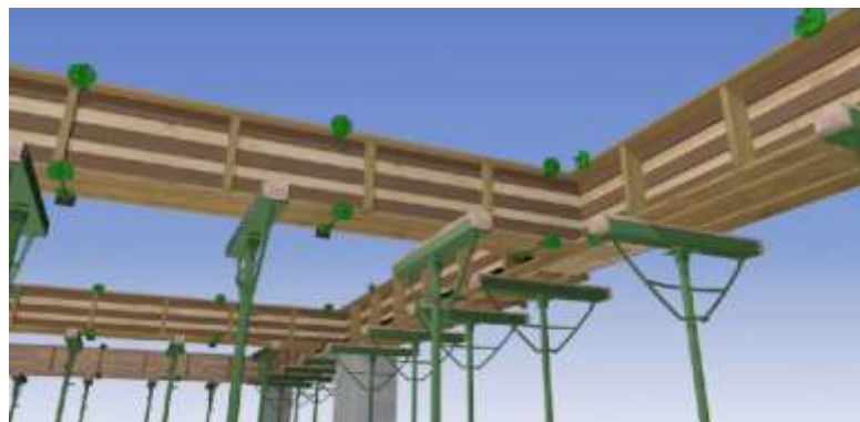
Figura 25 – Sistema de escoramento metálico para vigas
