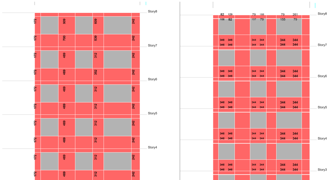
Figura 32 – Dimensionamento piers e spandrels
