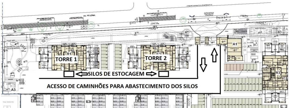
Figura 14 – layout canteiro de obras
