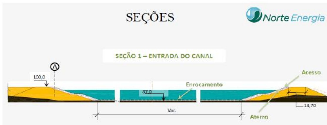
Figura 15: Seção do Canal de Derivação.
