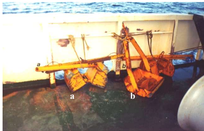
Figura 4. Amostradores de fundo do tipo: (a) van Veen; (b) draga de arrasto.
