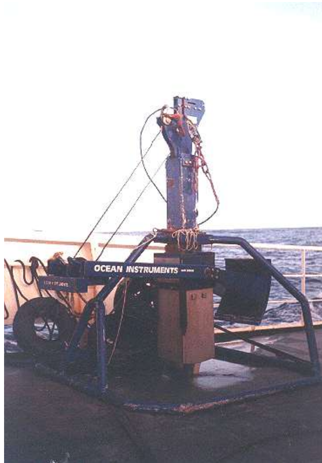
Figura 3. Amostrador de fundo do tipo Box Corer.
