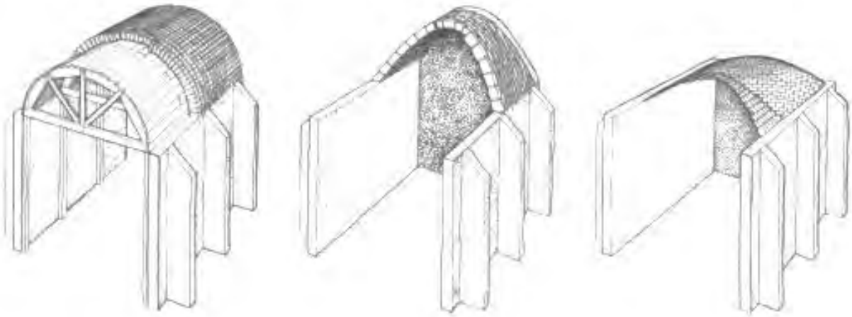
Figura 16: da esquerda para a direita: abóbadas tradicionais europeia, catalã e do oriente médio segundo ALLEN
