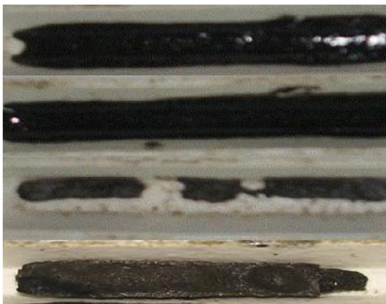
Figura 28: Cinzas dos carvões 1, 2, 3 e 4 (de cima para baixo, respectivamente) após o ensaio na temperatura de 1500°C.
