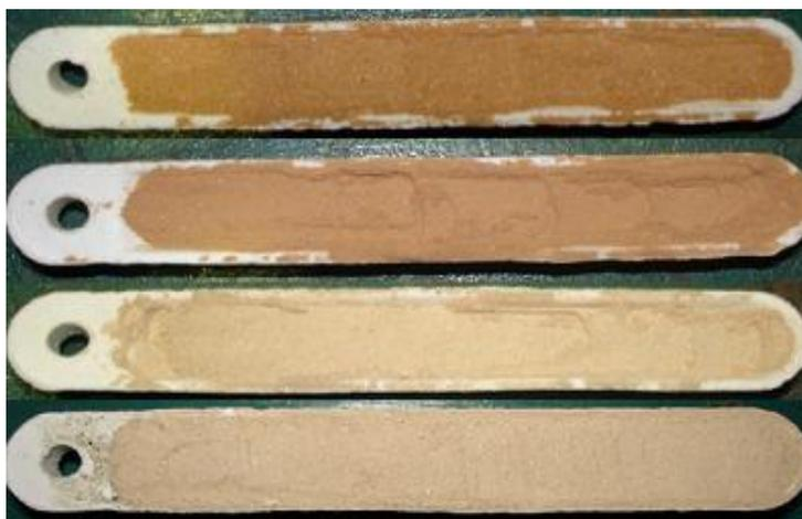
Figura 24: Amostras das cinzas (1, 2, 3 e 4 de cima para baixo, respectivamente) antes do aquecimento no forno mufla a 850°C.
