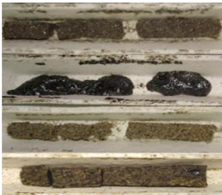
Figura 26: Cinzas dos carvões 1, 2, 3 e 4 (de cima para baixo, respectivamente) após o ensaio na temperatura de 1300°C.
