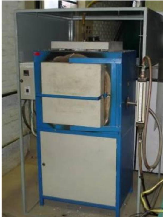
Figura 8: Forno mufla onde se realizou a etapa de preparação das cinzas.
