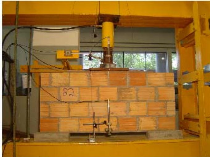
**Figura 5-33: Vista frontal do espécime B2 instrumentado antes da ruptura.**
