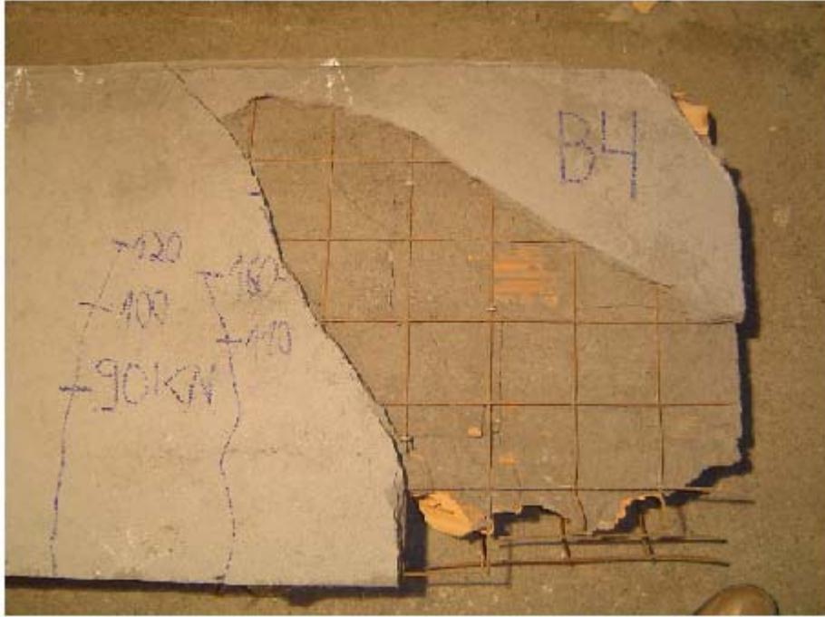
**Figura 5-44: Deslocamento e exposição das armaduras, após a queda do espécime B4.**
