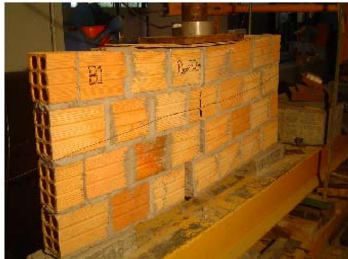
**Figura 5-31: Perspectiva do espécime B1 após a ruptura.**
