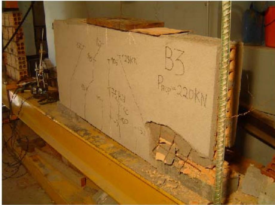
Figura 5-40: Perspectiva geral da ruptura e fissuração do espécime B3.
