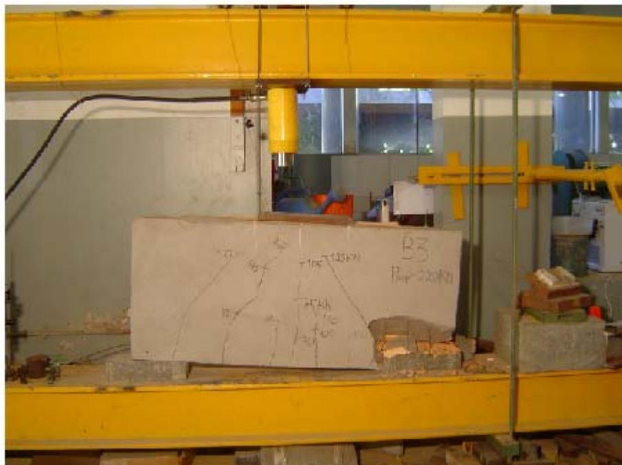
Figura 5-39: Fissuração final e forma de ruptura do espécime B3.
