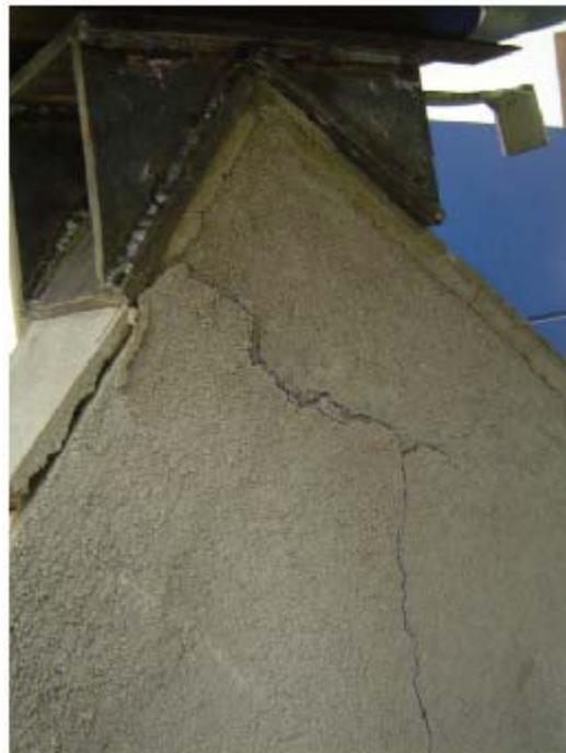
**Figura 5-25: Fotografia do ensaio do espécime A4 mostrando o destacamento do revestimento próximo a região de aplicação de carga.**
