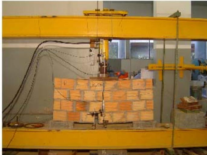
**Figura 5-30: Vista frontal do espécime B1 após ruptura.**
