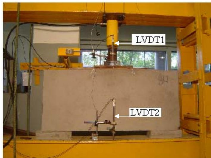
Figura 5-18: Posicionamento dos LVDT's em um espécime do Grupo B.
