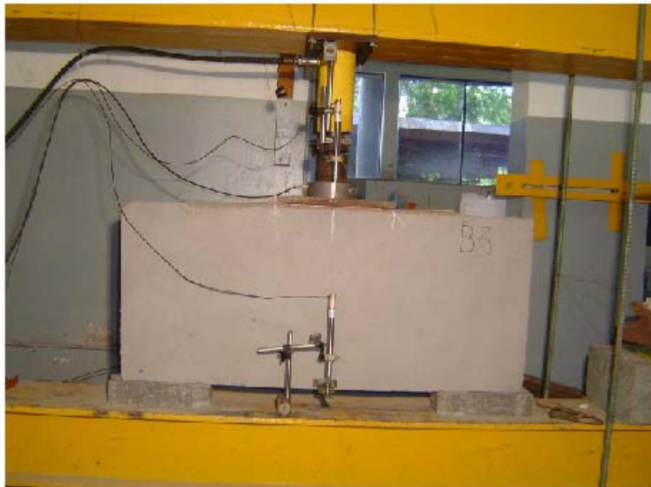
Figura 5-37: Espécime B3 instrumentado antes da aplicação de carregamento.
