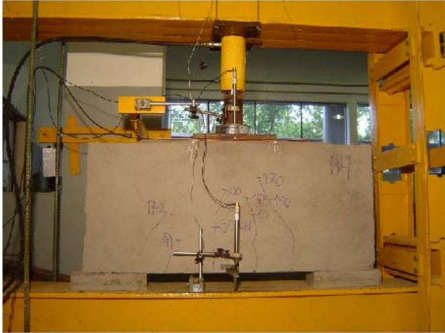
**Figura 5-42: Fissuração observada no espécime B4 antes da ruptura.**
