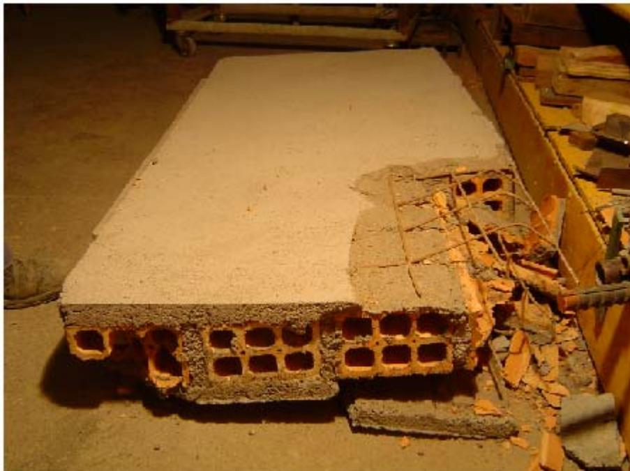
**Figura 5-43: Ruptura e queda do espécime B4, ficando expostas as armaduras flambadas.**
