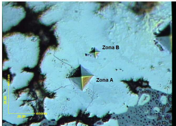
Figura 98 - Imagem por microscopia ótica mostrando impressões feitas na Região 1 da amostra L7.7-1113-15. São identificadas medidas de microdureza na Zona A (região central de um grão) e Zona B (região periférica de um grão contíguo)
