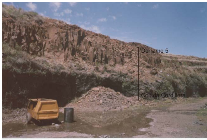
Figura 8 – Frente de mineração na colada Cordillera. Acima da colada Cordillera está o derrame estéril número 5, estruturado pelo tipo II que desenvolve disjunção colunar e entablamentos bem definidos. A entrada das galerias tem em média 2m de altura.
