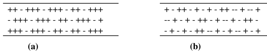
Figura 4. Efeito da neutralização sobre couros curtidos ao cromo: a) couro curtido; b) couro neutralizado. 11
