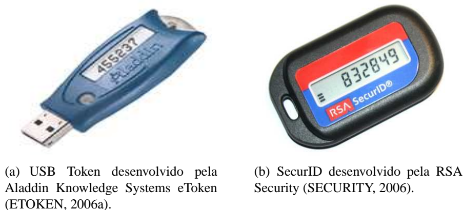
Figura 2.4: Exemplos de tokens criptográficos.
