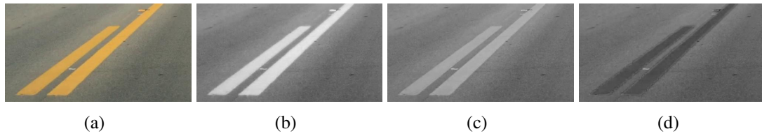
Figura 4.14 – Imagem com marcação de pista: (a) imagem RGB, (b) canal R, (c) canal G, (d) canal B.
