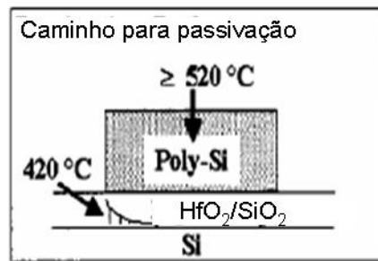
Figura 2.3-3: Possíveis caminhos do hidrogênio na etapa de passivação em capacitores poli-Si/HfO 2 /SiO 2 /Si. Adaptado de [134].
