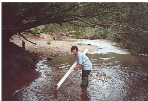
FIGURA 13 - Coleta de sedimento superficial com amostrador de PVC
