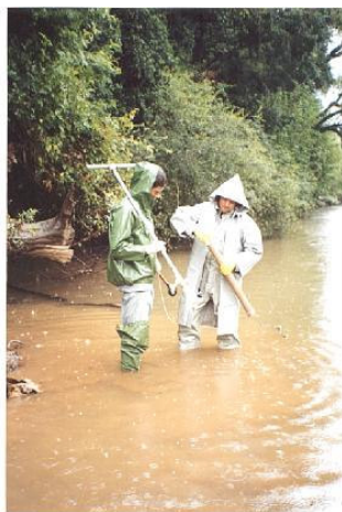
FIGURA 14 - Coleta de perfis sedimentares no ponto CAD002
