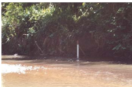
FIGURA 16 - Régua instalada para leitura do nível de água (ponto CAD003) e medição de vazão por técnicos do Instituto de Pesquisas Hidráulicas (ponto CAD001)
