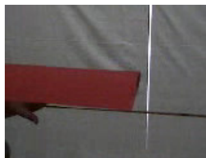
Figura 5.31 – Aerofólio com ângulo de ataque positivo nas proximidades de um indicador de movimento de ar.
