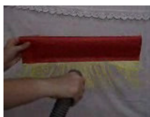
Figura 5.30 – Aspirador de pó expelindo ar contra um aerofólio.
