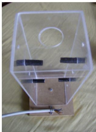
FIGURA 6: suporte de acrílico com a base de madeira e os tubos plásticos laterais.
