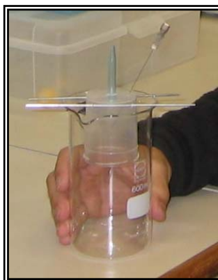
Figura 11. Fotografia salientando a construção da câmara formadora de bolhas.
