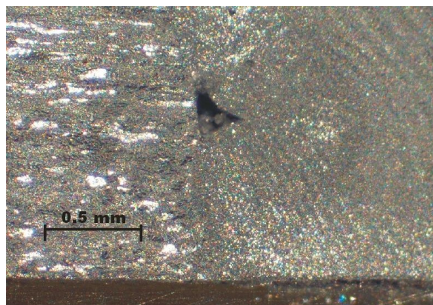
Figura 6.18 – Detalhe da descontinuidade na soldagem com geometria cônica lisa.
