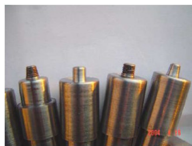
Figura 3.8 – Ferramentas empregadas na soldagem de Al 2014. (Zhao, Lin e Qu, 2005)
