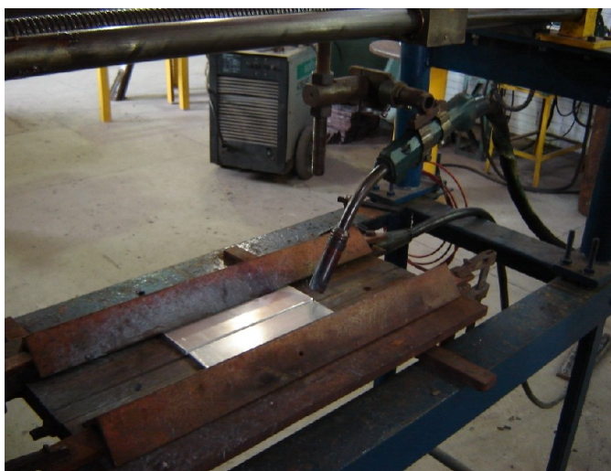
Figura 5.2 – Dispositivo utilizado na soldagem MIG semi-automática.
