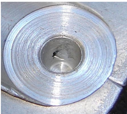
Figura 6.8 – Descontinuidade observada no furo remanescente.
