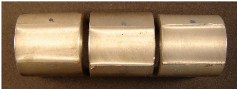
Figura 6.11 – Dobramento transversal de face - Ferramenta cônica lisa.
