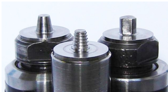
Figura 4.7 – Detalhes do ombro e pino.
