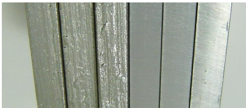
Figura 4.2 – Acabamento do chanfro para soldagem pelo processo FSW.
