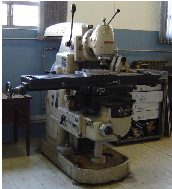
Figura 4.4 – Máquina fresadora universal utilizada na soldagem FSW.
