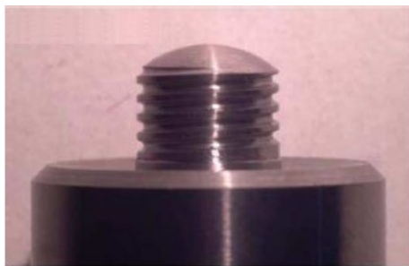
Figura 3.7 – Geometria utilizada na soldagem de compósitos de Al. (Liu et al, 2005)
