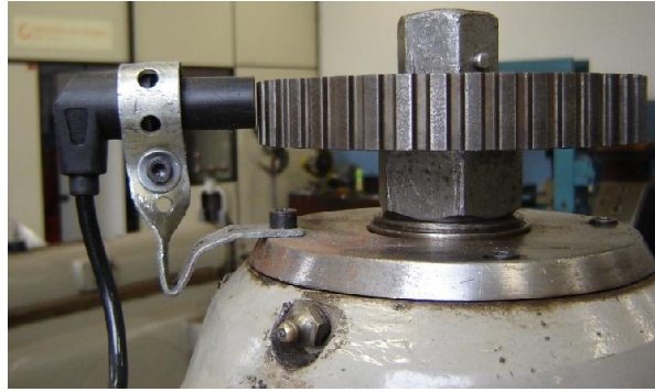
Figura 4.5 – Sensor automotivo de rotação adaptado.
