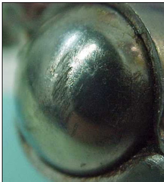
Figura 53 - Defeito localizado em esfera de um rolamento 6207. Posição 1 (LOA) do mancal da bomba centrífuga horizontal simples estágio 02B03A
