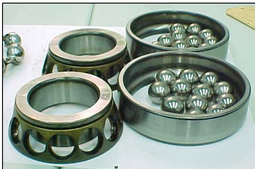
Estado geral dos componentes de rolamentos 7312 BEP Posições 2 e 3 (LA) do mancal da bomba centrífuga horizontal simples estágio 03B02B
