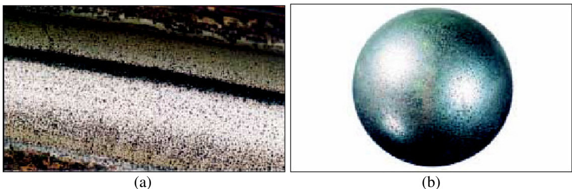
Figura 25 - [NSK, 2001] Pitting sobre a pista do anel externo (a) e o elemento rolante (b) de um rolamento axial, provocado pela exposição ao meio ambiente.
