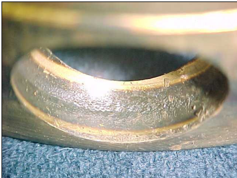
Figura 61 - Detalhe do alojamento da esfera na gaiola 7312 BEP. Posição 2 (LA) do mancal da bomba centrífuga horizontal simples estágio 03B03A
