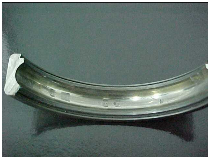
Figura 63 - Aspecto geral da pista externa do rolamento 6212. Posição 1 (LOA) do mancal da bomba centrífuga horizontal simples estágio 03B03A
