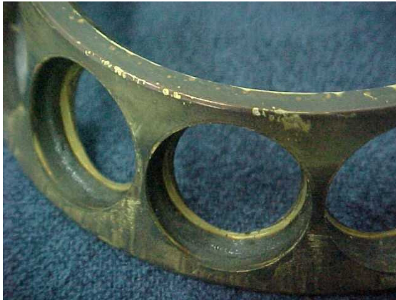
Figura 60 - Aspecto geral da gaiola do rolamento 7312 BEP. Posição 2 (LA) do mancal da bomba centrífuga horizontal simples estágio 03B03A
