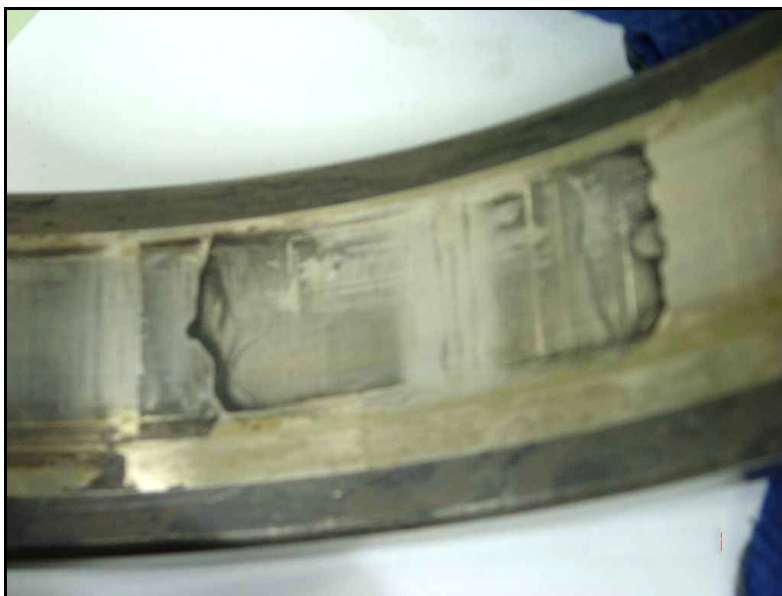
Corrosão por contato observada sobre pista externa de um rolamento NU 322 C3. Evidência de longos períodos com o motor parado, fora de operação. Possibilidade de contaminação do lubrificante. Posição 4 (LA) do mancal do motor elétrico acionador da bomba centrífuga horizontal simples estágio 13B11B.
