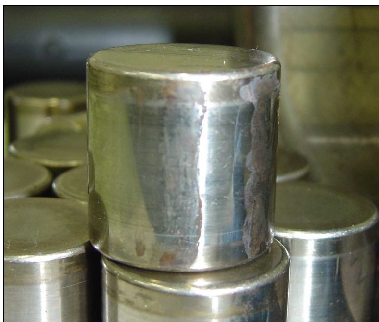
Detalhe de pontos de corrosão na superfície do rolo de um rolamento NU 322 C3. Evidência de longos períodos com o motor parado, fora de operação. Posição 4 (LA) do mancal do motor elétrico acionador da bomba centrífuga horizontal simples estágio 13B11B.
