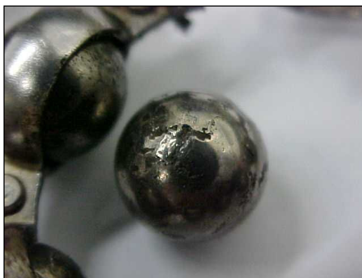
Figura 70 - Detalhe do dano localizado em esfera do rolamento 6205. Posição 2 (LA) do mancal da bomba centrífuga horizontal simples estágio 22B12B.
