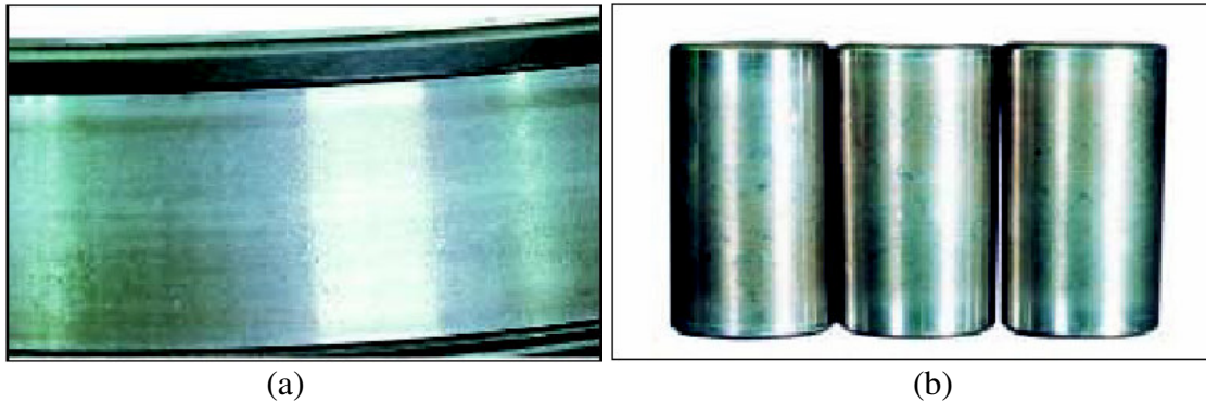
Figura 21 - [NSK, 2001] Impressões provocadas pela presença de impurezas sobre a pista do anel interno de um rolamento de rolos cônicos (a), e sobre os elementos rolantes de um rolamento de rolos cilíndricos (b).
