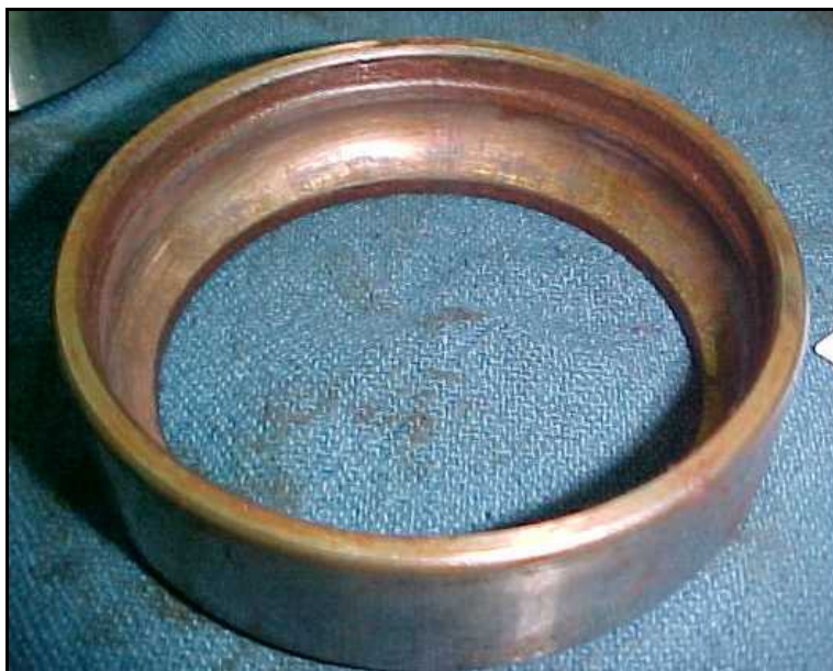
Estado geral da pista externa de um rolamento 7312 BEP. Evidência de corrosão severa por contaminação do óleo lubrificante. Posição 3 (LA) do mancal da bomba centrífuga horizontal simples estágio 23B04A.
