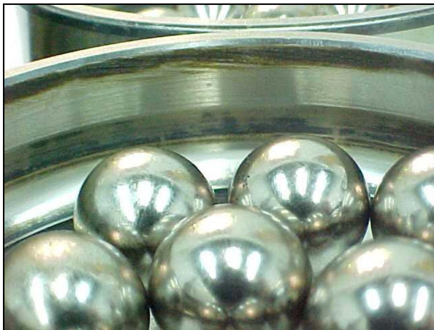
Detalhe da pista externa, e estado geral das esferas de um rolamento 7312 BEP. Sinais de oxidação na pista ocasionados por contaminação do óleo lubrificante. Leve oxidação na superfície das esferas do rolamento. Posição 2 (LA) do mancal da bomba centrífuga horizontal simples estágio 03B02B
