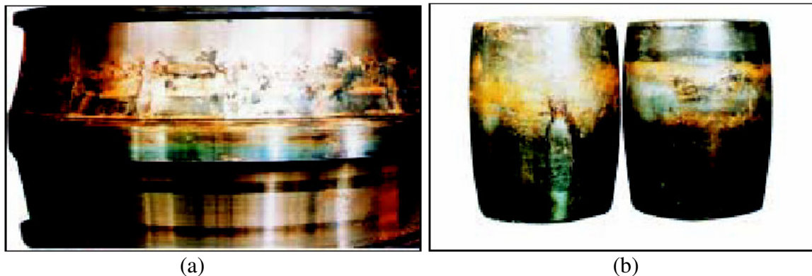
Figura 30 - [NSK, 2001] Superaquecimento observado sobre o anel interno (a) e elementos rolantes (b) de um rolamento auto-compensador de rolos. Lubrificação deficiente ocasionou a falha.
