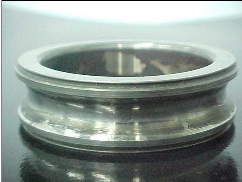
Figura 62 - Aspecto geral da pista interna do rolamento 6212. Posição 1 (LOA) do mancal da bomba centrífuga horizontal simples estágio 03B03A
