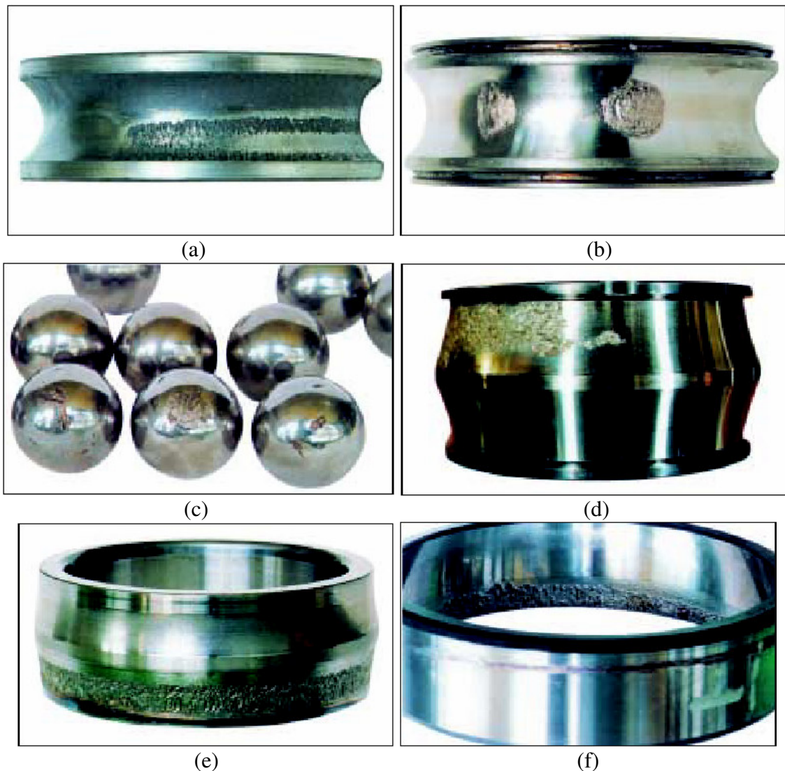
Figura 18 - [NSK, 2001] Escamamento ocorrido em componentes de rolamentos. (a) na pista interna em decorrência de desalinhamento na montagem; (b) e (c) marcas na pista interna e esferas, respectivamente, por impacto na montagem; (d) descascamento localizado da pista interna em decorrência de lubrificação deficiente; (e) e (f) nas pistas interna e externa do mesmo rolamento, em decorrência de sobrecarga na direção axial.
