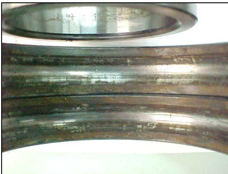
Defeitos ao longo de toda a pista externa ocasionadas por corrosão em um rolamento 6212 Posição 1 (LOA) do mancal da bomba centrífuga horizontal simples estágio 03B02B
