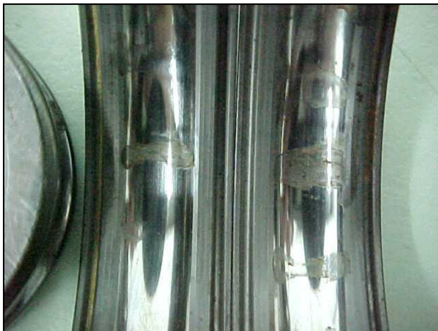
Detalhe de pontos de corrosão sob contato na superfície da pista externa de um rolamento 6206 ZZ. Evidência de longos períodos com o motor parado, fora de operação. Posição 4 (LA) do mancal do motor elétrico acionador da bomba centrífuga simples estágio 112B14B.
