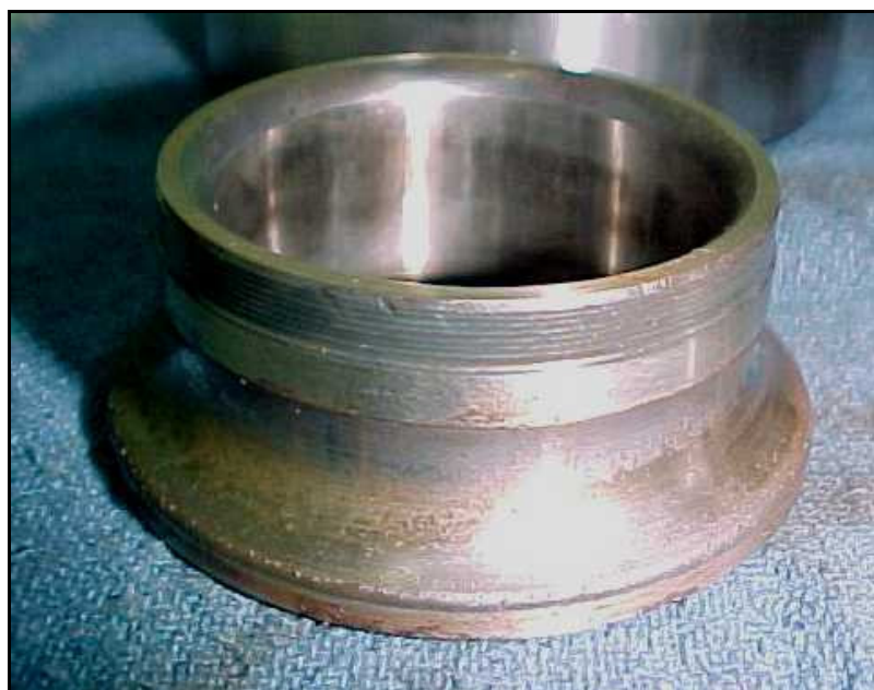
Estado geral da pista interna de um rolamento 7312 BEP. Evidência de corrosão severa por contaminação do óleo lubrificante. Posição 2 (LA) do mancal da bomba centrífuga horizontal simples estágio 23B04A.
