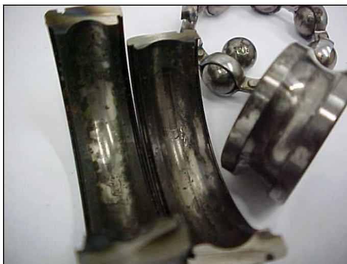
Figura 67 - Aspecto geral das pistas externa e interna do rolamento 6304 NR. Posição 1 (LOA) do mancal da bomba centrífuga horizontal simples estágio 22B12B
