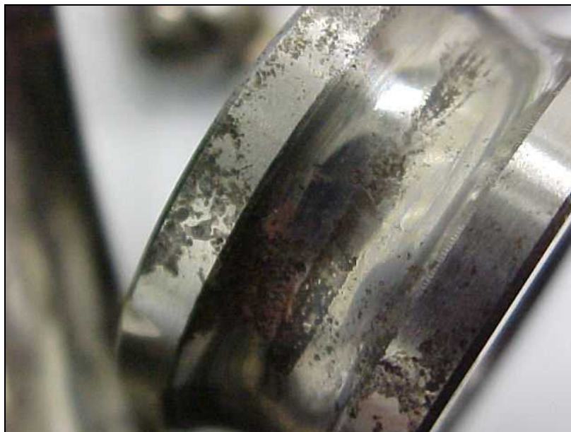
Figura 69 - Detalhe da pista interna do rolamento 6304 NR. Posição 1 (LOA) do mancal da bomba centrífuga horizontal simples estágio 22B12B
