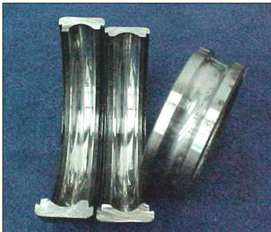
Figura 74 - Aspecto geral das pistas externa e interna do rolamento 6314 C3. Posição 4 (LA) do mancal do motor elétrico 13MB02A
