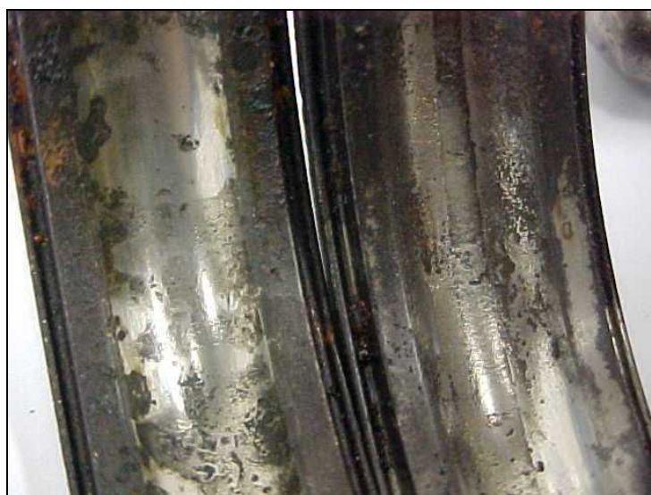
Figura 68 - Detalhe da pista externa do rolamento 6304 NR. Posição 1 (LOA) do mancal da bomba centrífuga horizontal simples estágio 22B12B
