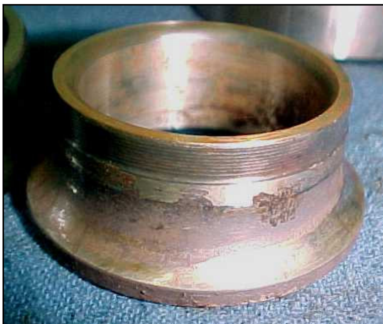
Estado geral da pista interna de um rolamento 7312 BEP. Evidência de corrosão severa por contaminação do óleo lubrificante. Defeitos com o espaçamento entre esferas. Posição 3 (LA) do mancal da bomba centrífuga horizontal simples estágio 23B04A.
