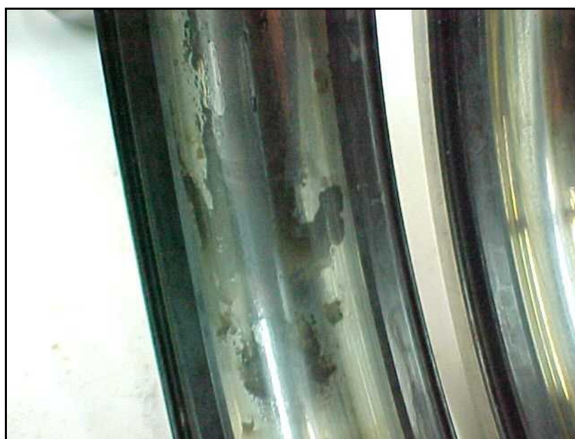
Detalhe da pista externa de um rolamento 6314 C3. Evidência de corrosão por contaminação do óleo lubrificante (água). Posição 4 (LA) do mancal do motor elétrico acionador da bomba centrífuga horizontal simples estágio 04B02A.
