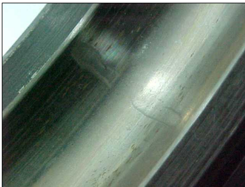
Detalhe da pista externa do rolamento 6314 C3.
