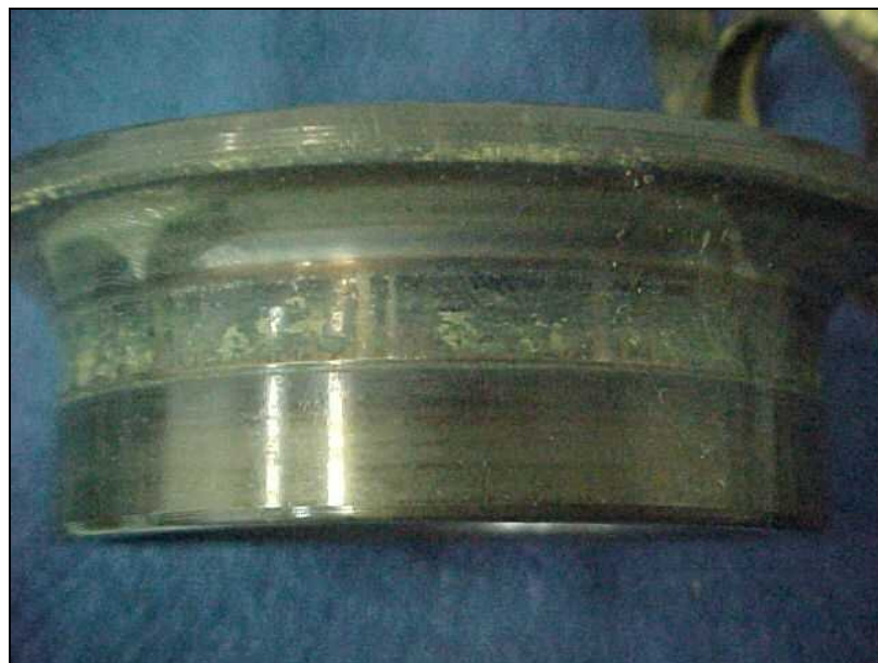
Figura 59 - Aspecto geral da pista interna do rolamento 7312 BEP. Posição 2 (LA) do mancal da bomba centrífuga horizontal simples estágio 03B03A
