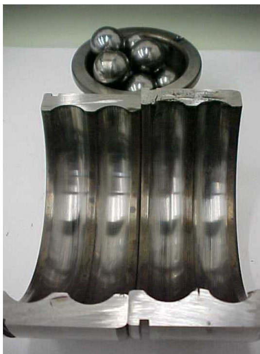
Aspecto geral dos componentes do rolamento 3309 A Posição 2 (LA) do mancal da bomba centrífuga horizontal simples estágio 13B01A
