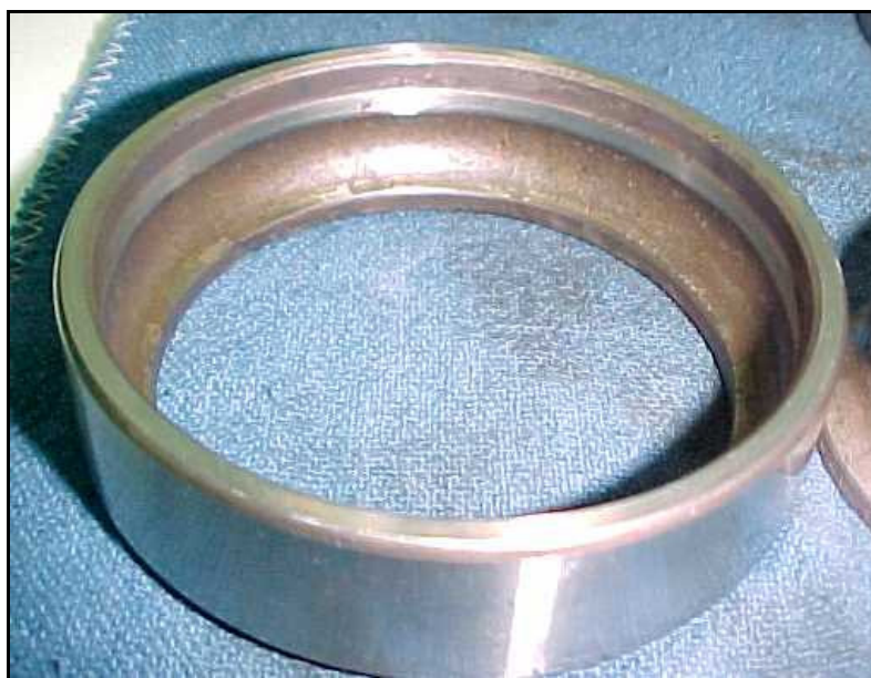
Estado geral da pista externa de um rolamento 7312 BEP. Evidência de corrosão severa por contaminação do óleo lubrificante. Posição 2 (LA) do mancal da bomba centrífuga horizontal simples estágio 23B04A.
