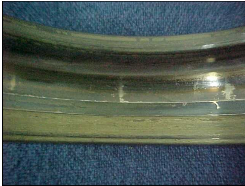
Figura 58 - Aspecto geral da pista externa do rolamento 7312 BEP. Posição 2 (LA) do mancal da bomba centrífuga horizontal simples estágio 03B03A
