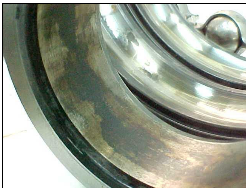
Corrosão por contato, observada na superfície de montagem do anel interno de um rolamento 6314 C3. Evidência de ajuste inadequado eixo-furo na montagem do rolamento. Posição 4 (LA) do mancal do motor elétrico acionador da bomba centrífuga horizontal simples estágio 04B02A.
