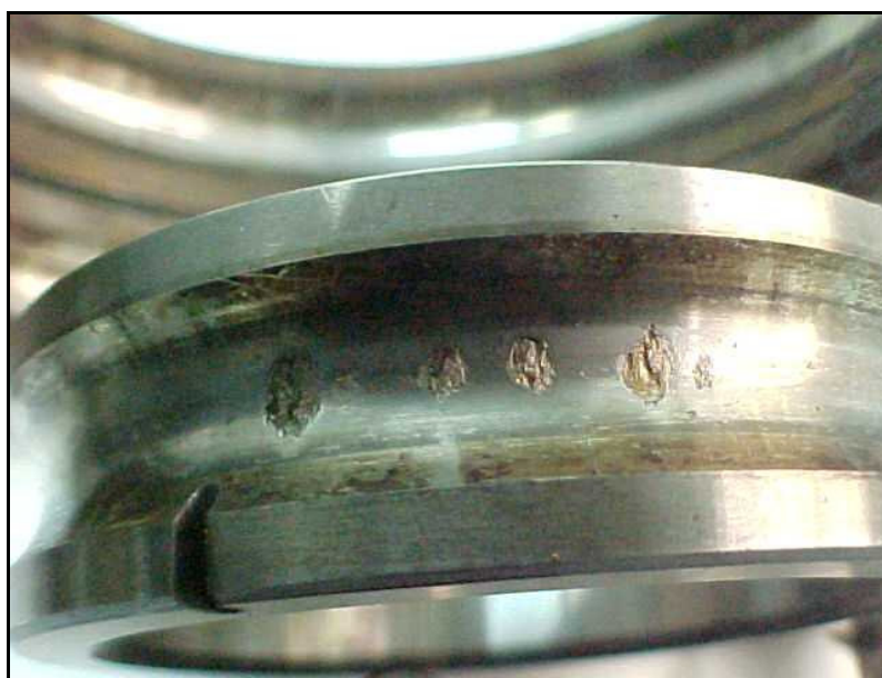
Defeitos localizados na pista interna ocasionados pelo contato com as esferas após longo período do equipamento fora de operação. Sinais de corrosão também evidentes. Rolamento 6212 Posição 1 (LOA) do mancal da bomba centrífuga horizontal simples estágio 03B02B
