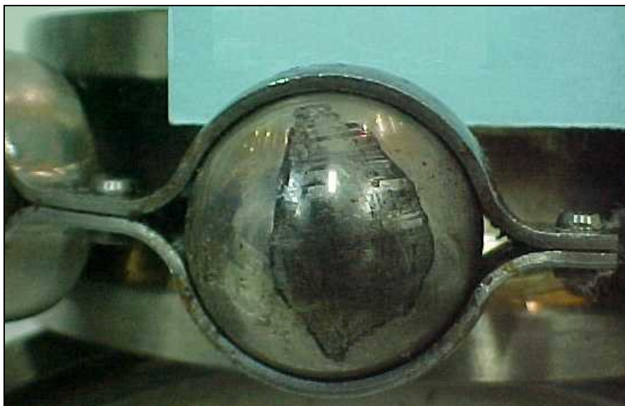
Defeito localizado em uma das esferas do rolamento 6314 C3. Posição 5 (LOA) do mancal do motor elétrico acionador da bomba centrífuga horizontal simples estágio 21B02A.
