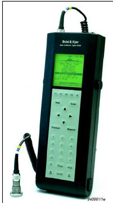
Figura 44 - [Brüel & Kjaer, 1998] Coletor portátil de vibração B&K 2526 E
