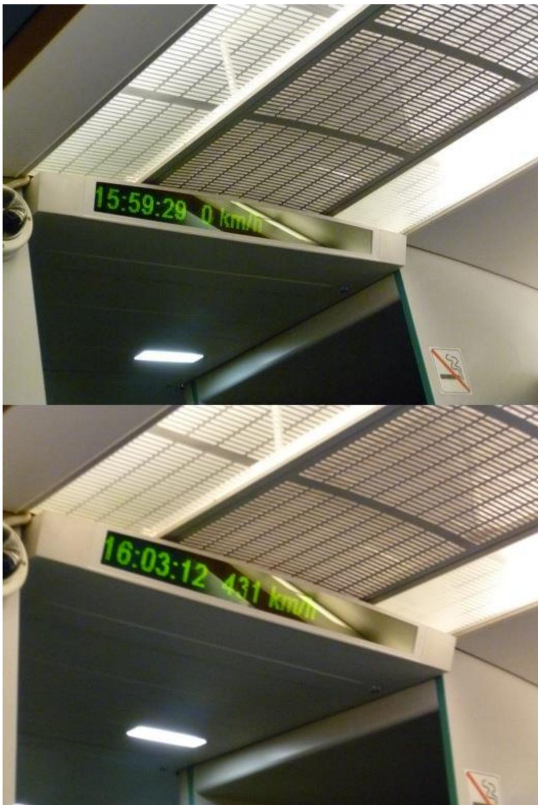
Figura 4- Imagens retiradas da Apresentação *Transrapid Train Shanghai*, utilizadas para calcular a aceleração deste trem.
