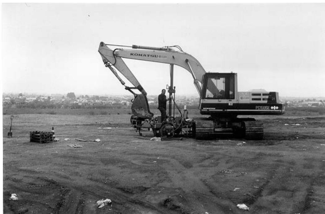
**Figura 3.10:** Sistema de reação do equipamento hidráulico de cravação para o ensaio de cone no aterro sanitário da Zona Norte de Porto Alegre.
