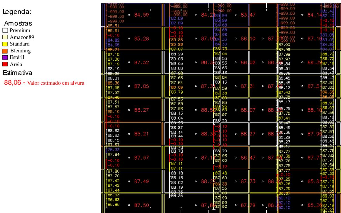
figura 5.66 - Perfil com os blocos e furos de sondagem com os respectivos valores associados aos intervalos amostrais e aos blocos estimados.
