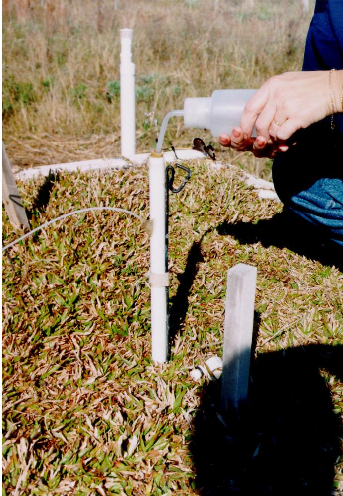
Figura 22 - Reposição de água no sistema
