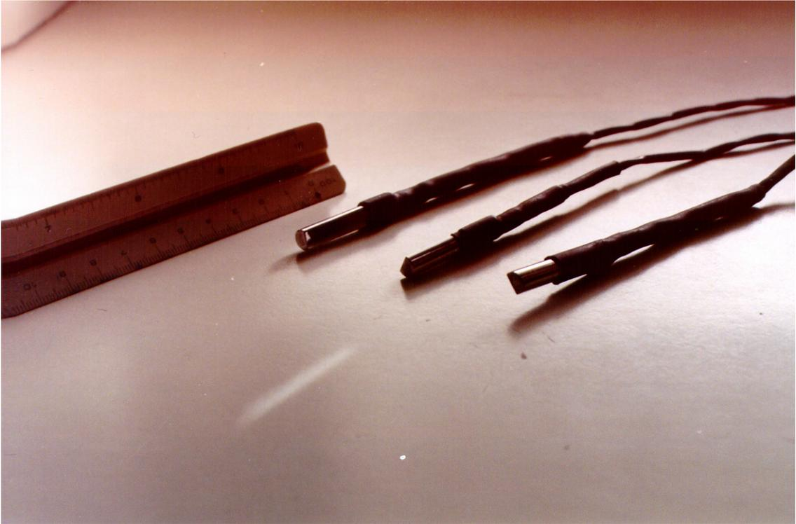
Figura 13 - Detalhe dos sensores tipo Pt 100 disponíveis
