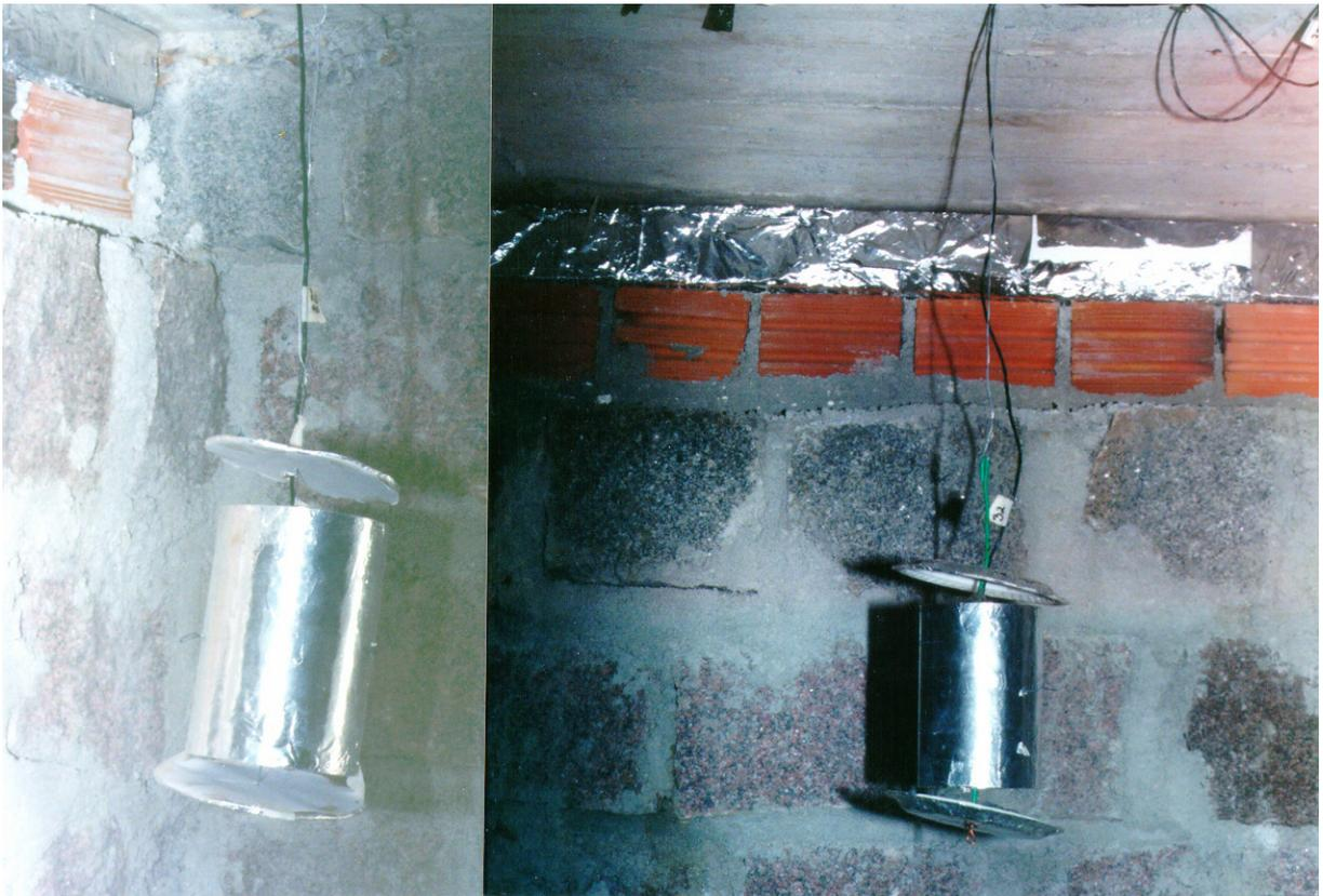
Figura 18 - Detalhe dos dispositivos de proteção dos sensores de temperatura do ar
