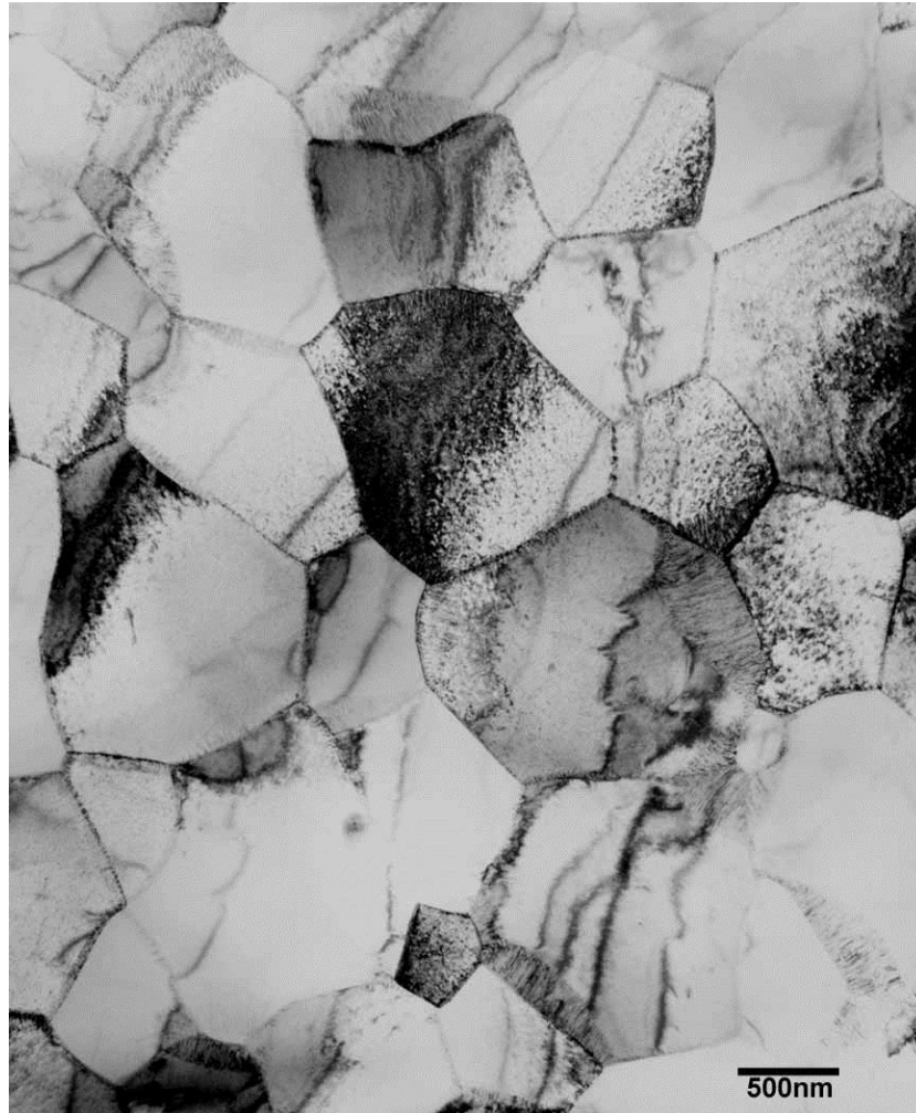
Figura 84 - \text{Cu}_{90}\text{Co}_{10} tratada até T_f = 873 \text{ K} e \phi = 8,9 \text{ K/min} . Vista geral indicando a presença de precipitação descontínua em praticamente todas as fronteiras de grão.
