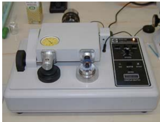
Figura 34 - Dimple Grinder, modelo 656 fabricado pela Gatan Inc.
