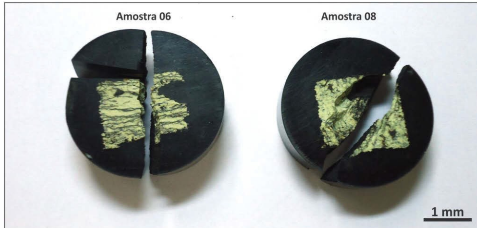
Figura 58: Resultado para o teste de embutimento das Amostras 06 e 08, no qual as duas amostras fraturaram quando da tentativa de retirada da amostra do embutimento.
