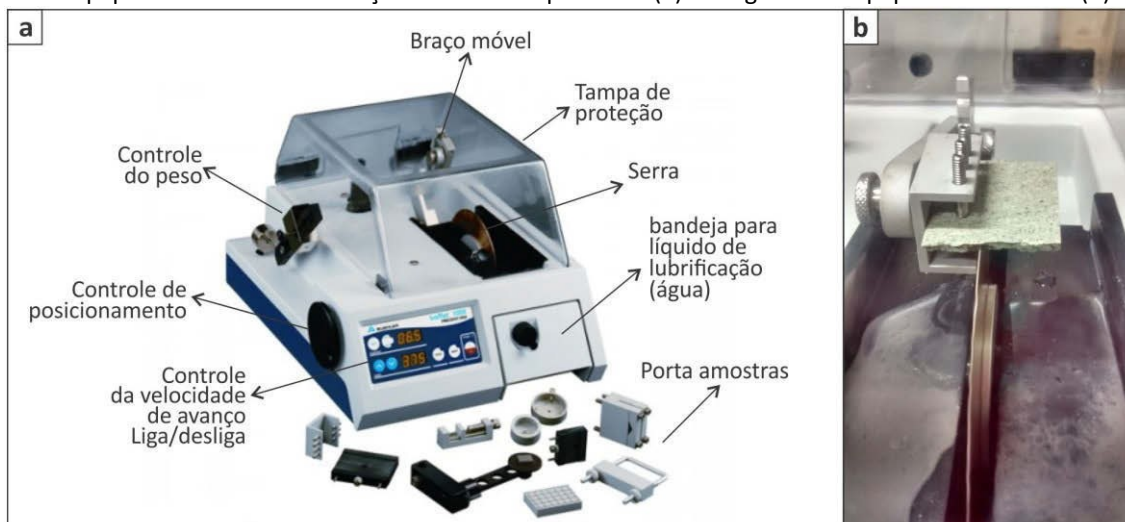
Figura 35: Equipamento utilizado na realização dos testes de corte de precisão com serra diamantada. Imagem do equipamento com identificação de seus componentes (a). Fotografia do equipamento em uso (b).
